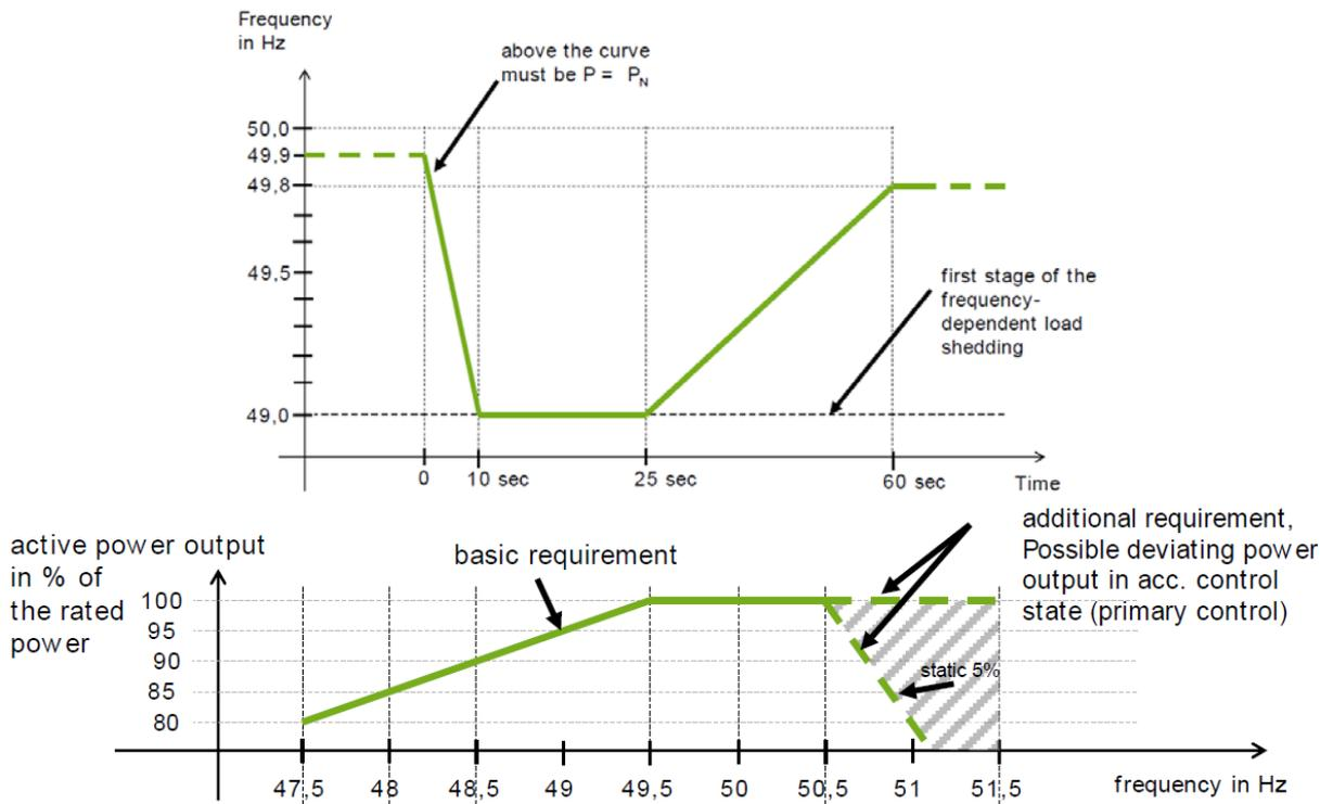
FIGURE 3: GERMAN GRID CODE (TENNET TSO GMBH)
